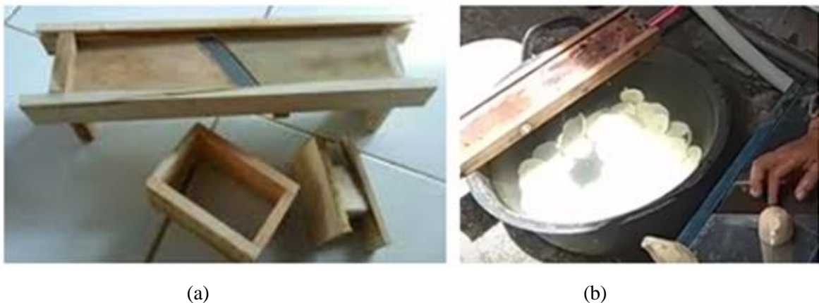
Gambar 2. (a) Alat Perajang Manual (b) Proses Perajangan Menggunakan Alat Manual
